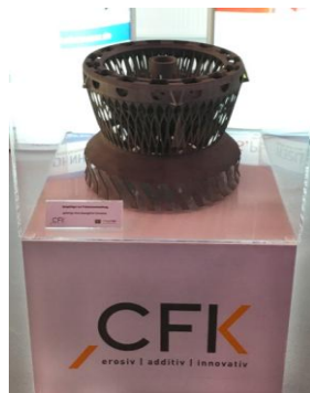
Justierhalter für Laserspiegel mit Festkörpergelenken - aufgebaut mit Selective Laser Melting (SLM) aus Titan Grade 2 © innos-Sperlich GmbH/CFK GmbH
